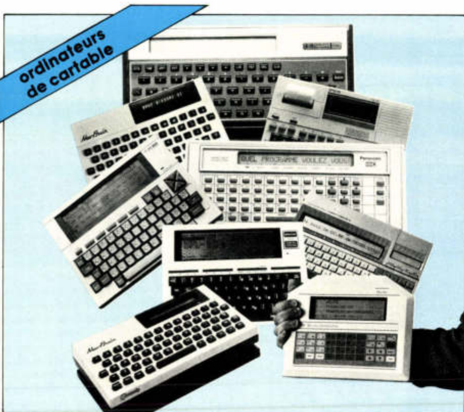
Les ordinateurs de cartable sont le résultat de technologies récentes : autonomes, avec affichage à cristaux liquides permettant de visualiser plusieurs lignes et comportant un vrai clavier ; tout cela pour un prix variant entre 3 000 et 10 000 FF.
